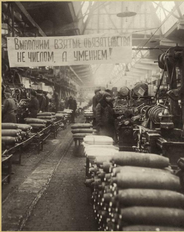
Поточное производство на заводе № 65 имени Сталина. Производство 122-мм осколочно-фугасной гаубичной гранаты. Общий вид потока механической обработки корпуса чистового предела
